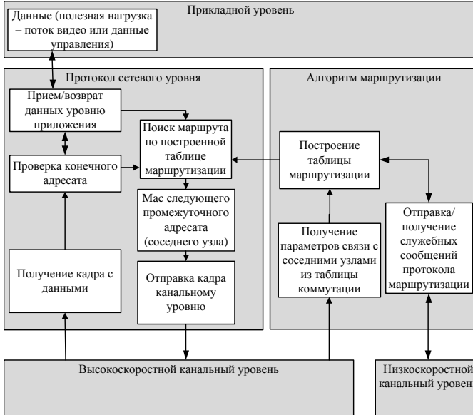
Рис. 1. Структурная схема обмена данными протокола сетевого уровня
