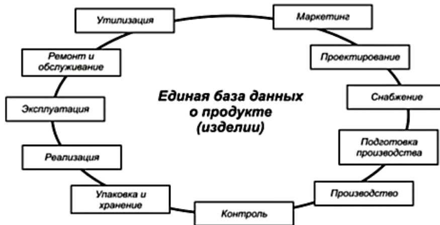
Рисунок 1– Обобщенная структура этапов жизненного цикла изделия в концепции PLM
