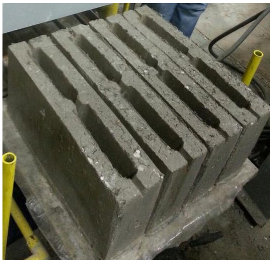
Рисунок 2 – Полублоки, полученные на промышленном прессе «Рифей»
