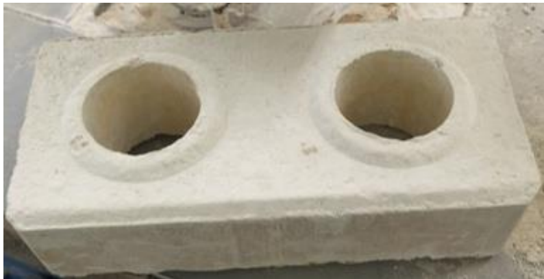
Рисунок 1 – Кирпич типа «лего», полученный на промышленном прессе «Рифей»
