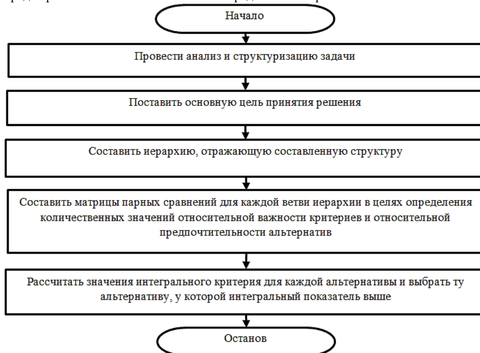
Рис. 3 – Блок-схема алгоритма решения задачи в соответствии с МАИ
