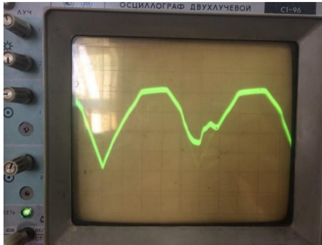
Рисунок 4 – Переходная характеристика диодного моста в эксперименте №2.
