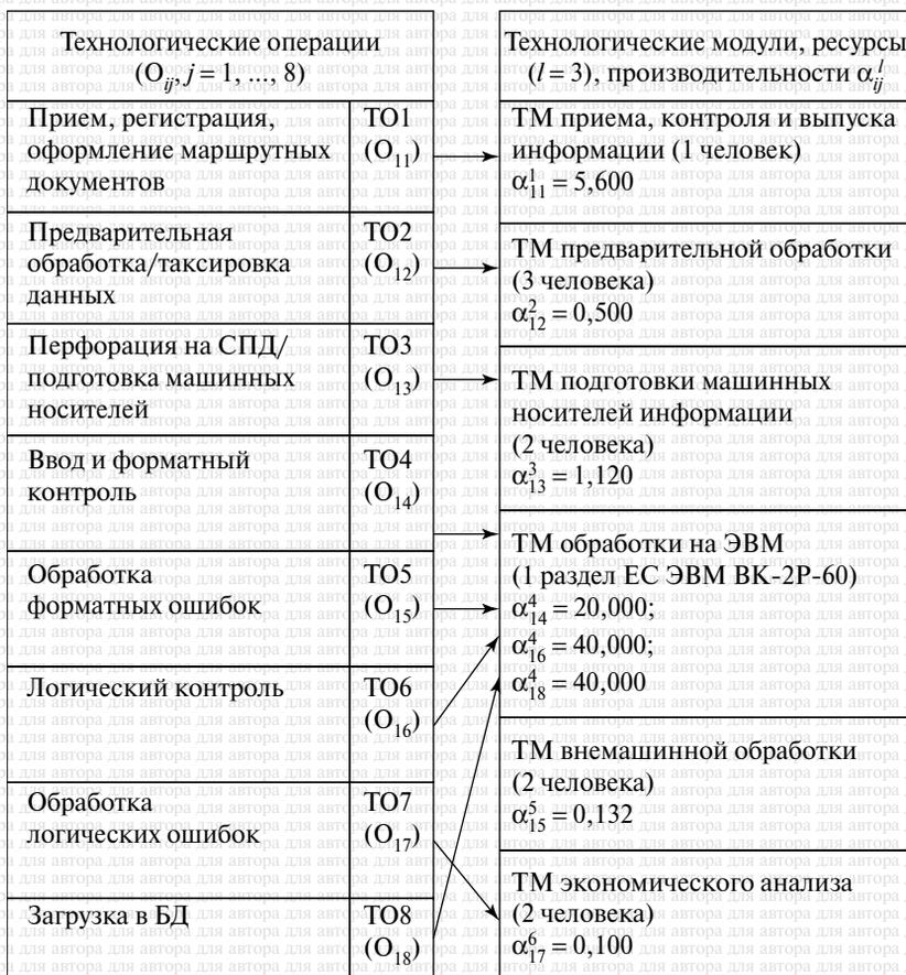
**Рис. 5.4.** Схема связи между технологическими операциями, операционными участками и ресурсами
