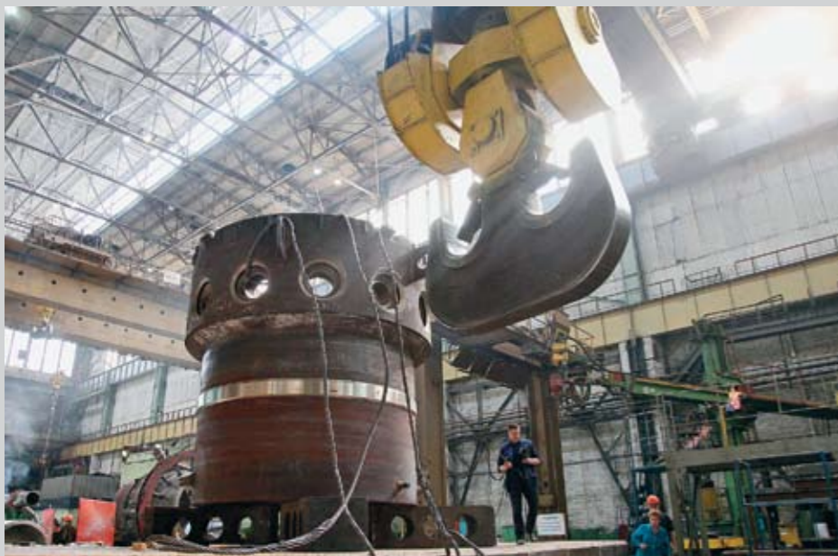
Перемещение полукорпуса с патрубками в печь
