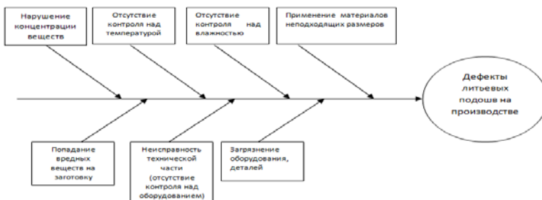
Рисунок 2. Диаграмма Исикавы причины, влияющие на появление дефектов на производстве литьевых подошв
