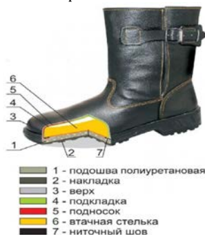
Рисунок 1. Компоненты низа обуви, изготовленного литьевым методом
