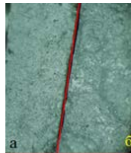
Фиг.4. Лом в областта на разрушаване на а/проба с термообработка б/проба без-термообработка
