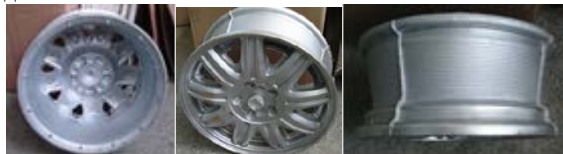
Фиг.1 Алуминиева лята джантата AlSi7Mg получен
