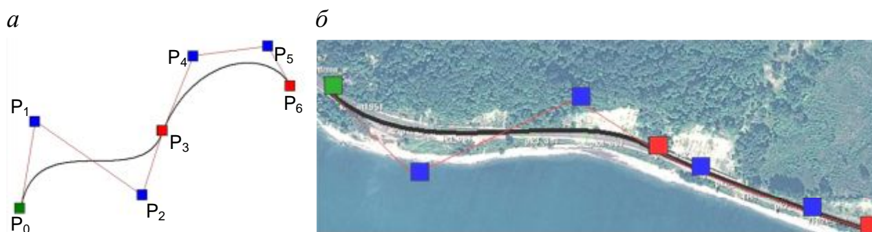
Рис. 1. Кубические сплайны Безье: сегментированный сплайн (а); моделирование участка сплайнами по топографическим данным (б)
