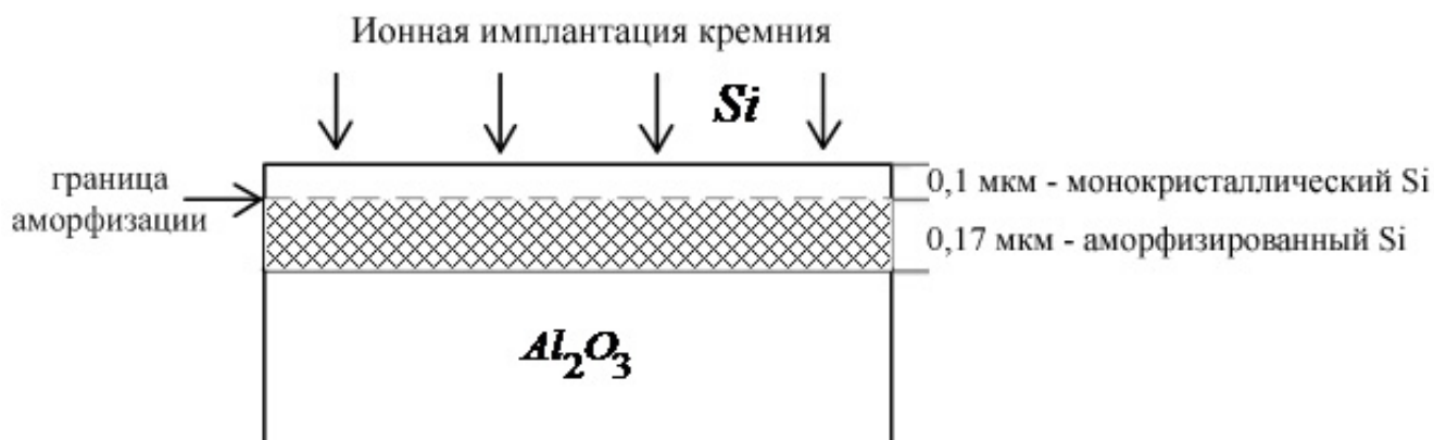
Рис. 3.22. Аморфизированная структура КНС
