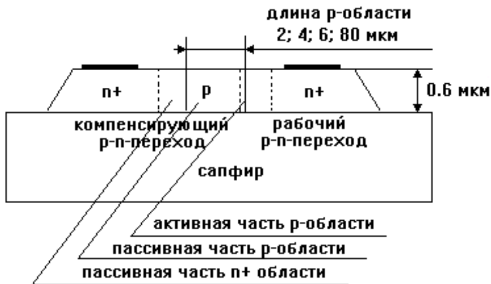
Рис. 4.15. Конструкция стабилитрона на основе структуры КНС МОП -
