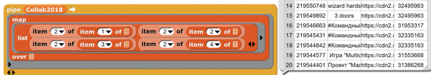
Рис. 42. Превращение JSON файла в таблицу SNAP!
