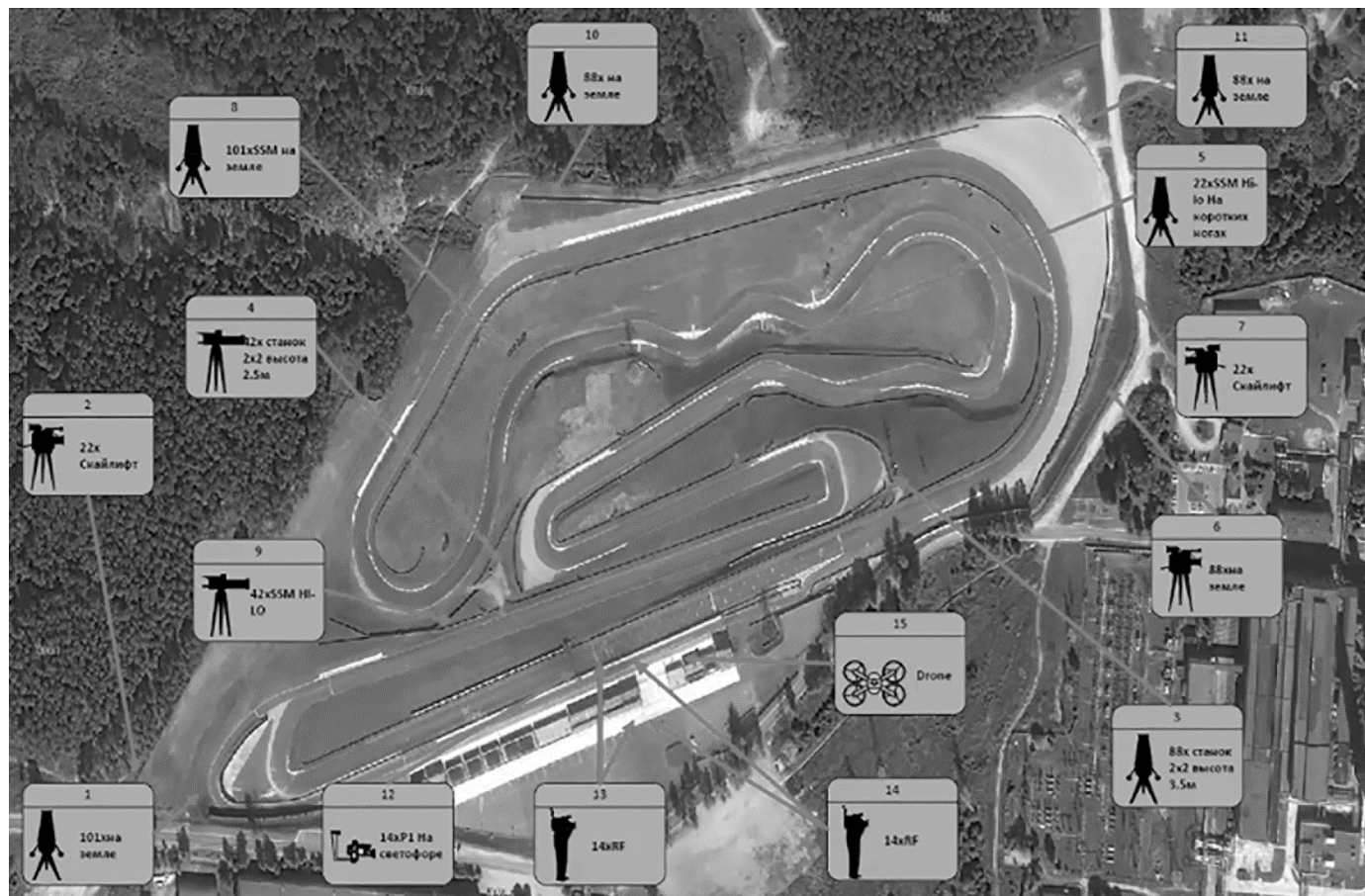
Рис. 4.2. Схема расстановки камер на примере автодрома «Смоленское кольцо»
