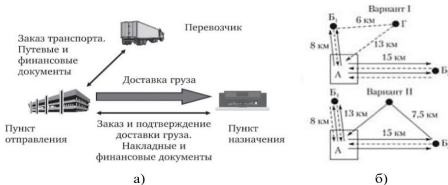
Рисунок 3 – Схема размещения потребителей (а) и варианты организации перевозок (б)
