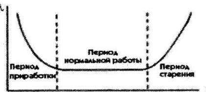
Рис. 1. Типовая зависимость интенсивности отказов ЭРИ от времени
