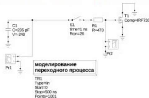
Рис. 3. Схема модели воздействия НВМ ЭСР на транзистор IRF730
