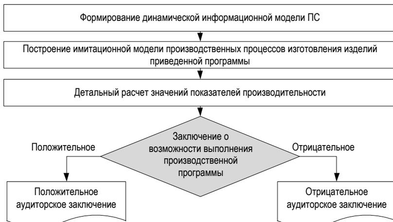
**Рис. 2. Алгоритм проведения второго этапа аудита производственно-логистической системы**
