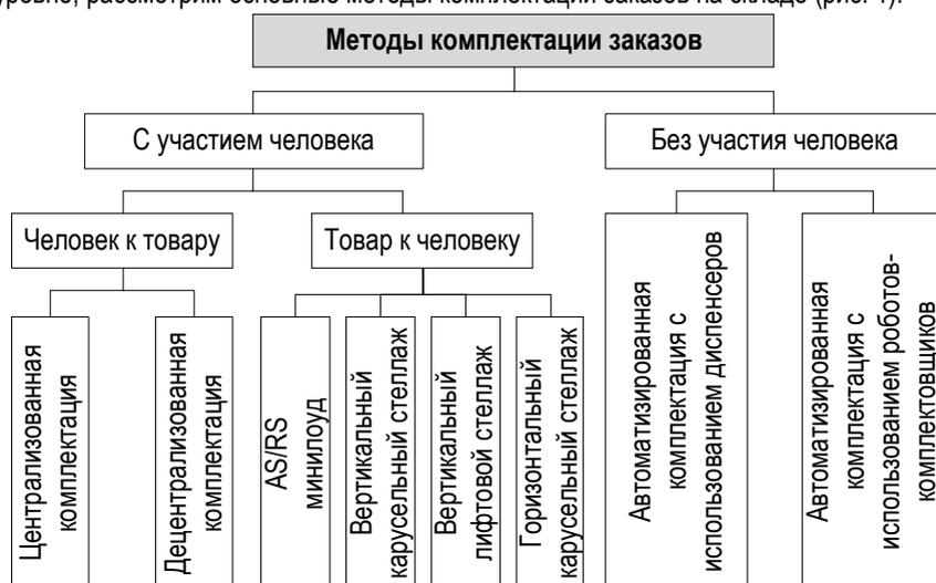
**Рис. 1. Методы комплектации заказов на складе**
