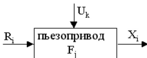
**Рис. 4.3.2.** Обобщённая модель пьезопривода:
