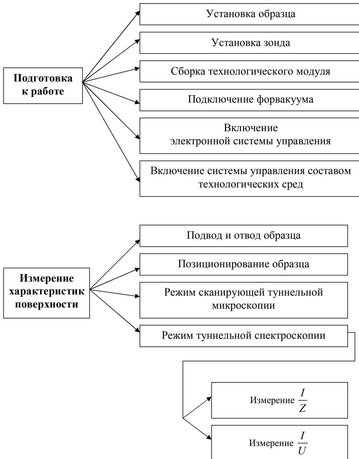
**Рис. 4.1.1.** Блок-схема режимов работы нанотехнологической установки
