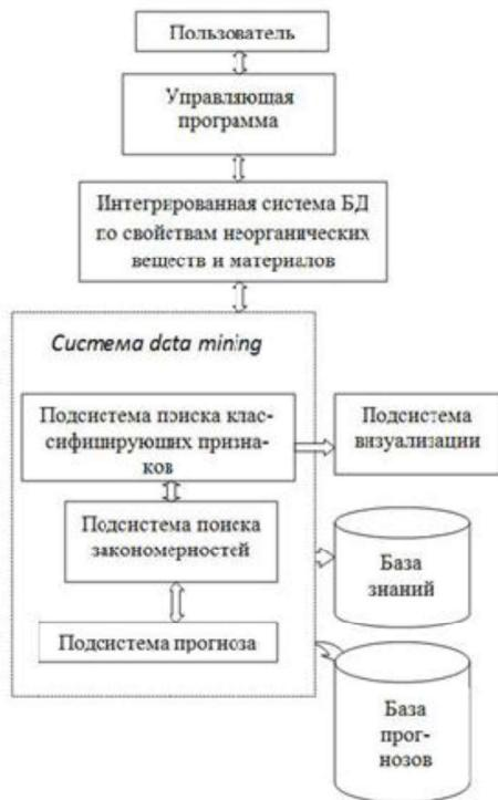
Рис. 1 Схема ИАС для поиска закономерностей в химической информации прогнозе новых соединений.
