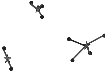
Рис. 7. Суммарные расстояния между точками, представляющими объекты, и центрами соответствующих кластеров, представленными звездами – суть критерия метода k -средних
