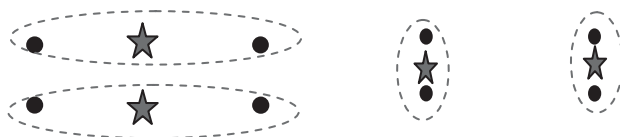
Рис. 10. Пример недостатка метода k -средних – зависимость кластеров от начальных центроидов, представленных звездочками: справа и слева показаны кластеры, возникающие при соответствующей инициализации. Правильные кластеры – те, что справа
