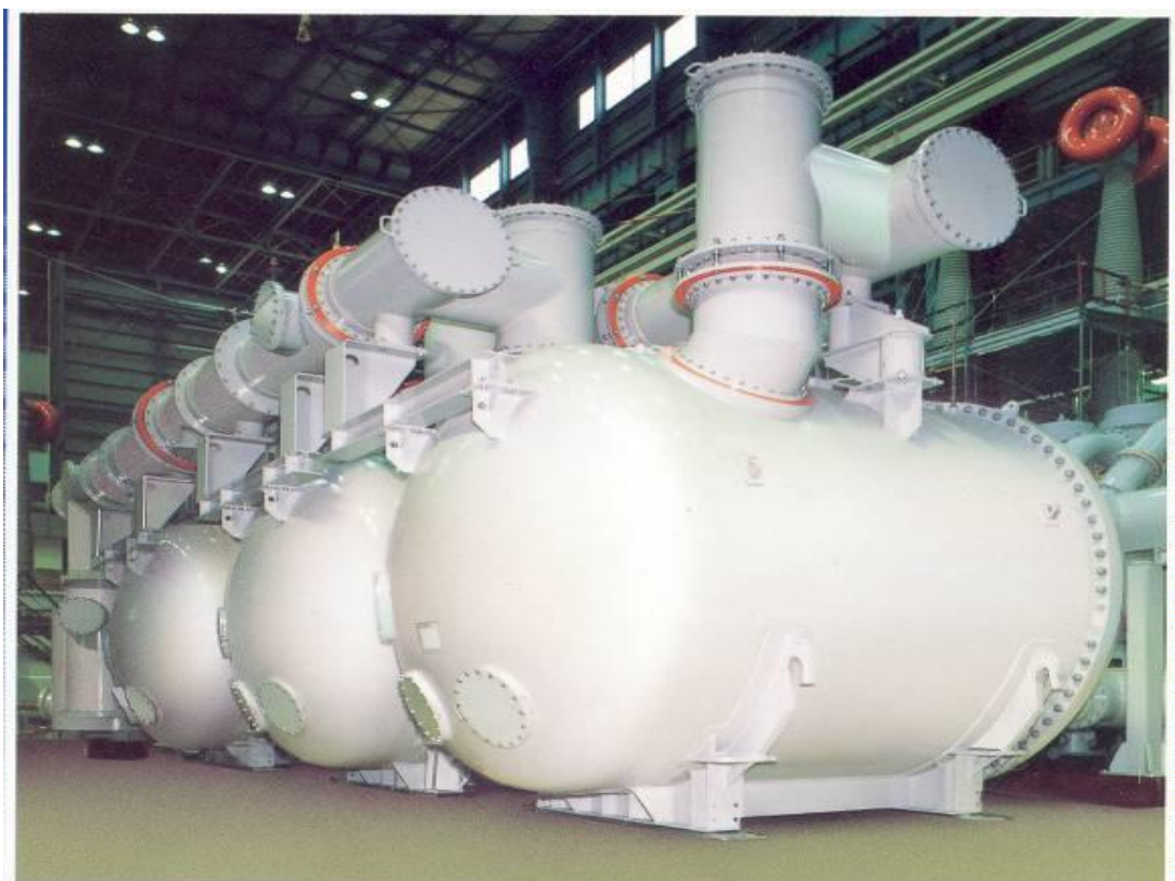
Рис. 2.16 Автоматизированная подстанция с элегазовыми трансформаторами для мегаполисов
