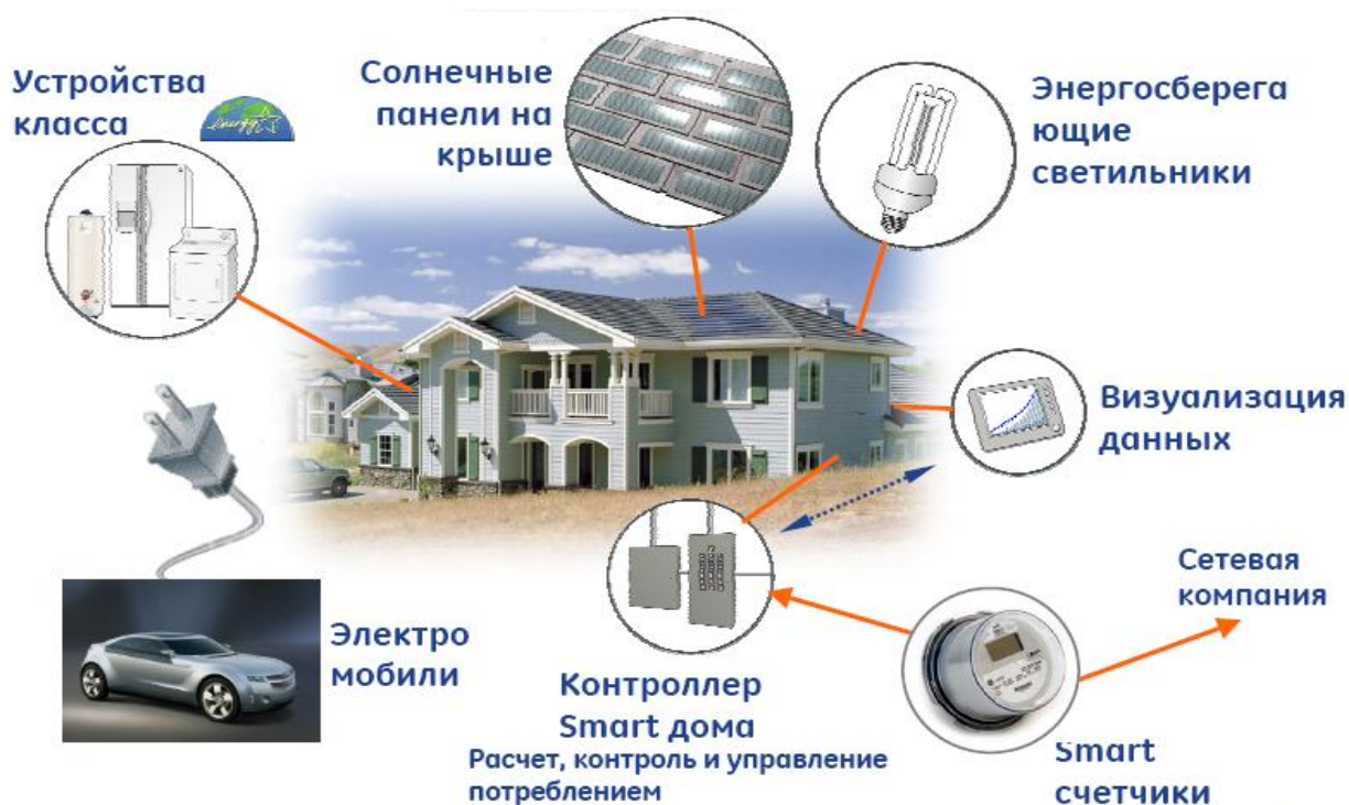
Рисунок 1.8 - Возможности потребителя в энергетической системе на базе концепции SmartGrid
