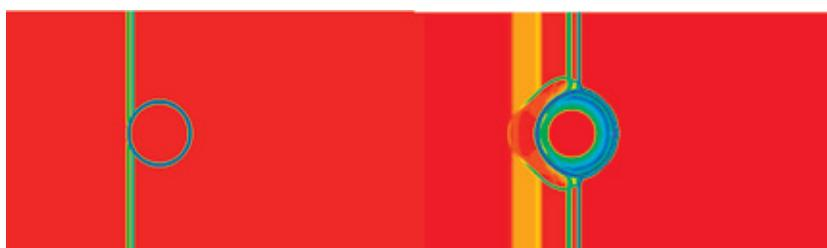
Рис. 2. Цифровой шлирен для градиента плотности при  $t = 0$  (слева) и при  $t = 7$  (справа)
