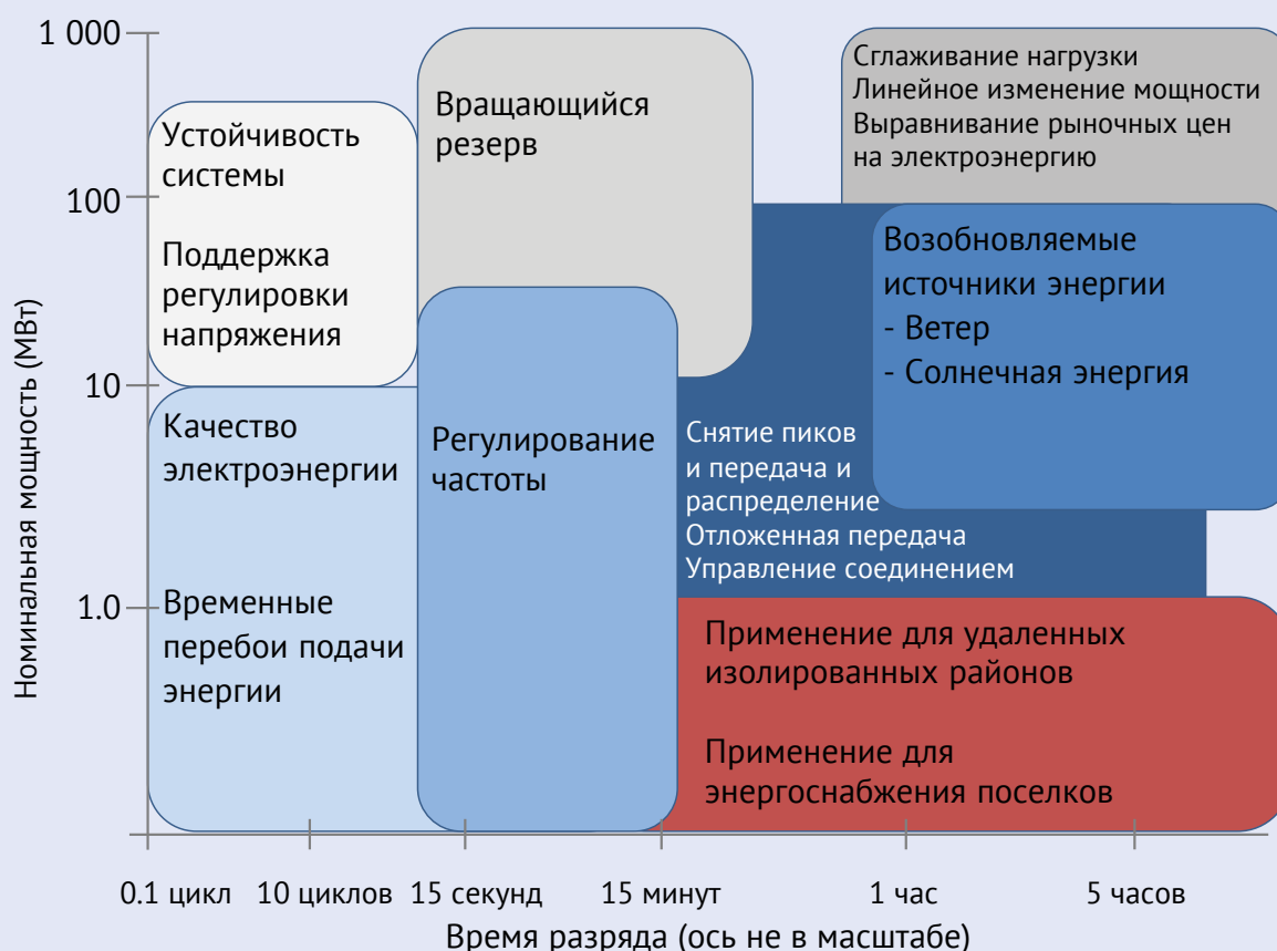
Рисунок 2.22 – Функциональное разнообразие систем накопления электроэнергии для решения задач в энергосистеме и у потребителей
