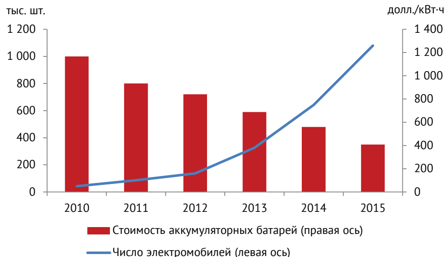
Рисунок 2.43 – Снижение стоимости аккумуляторных батарей на электромобилях, рост численности электромобильного парка
