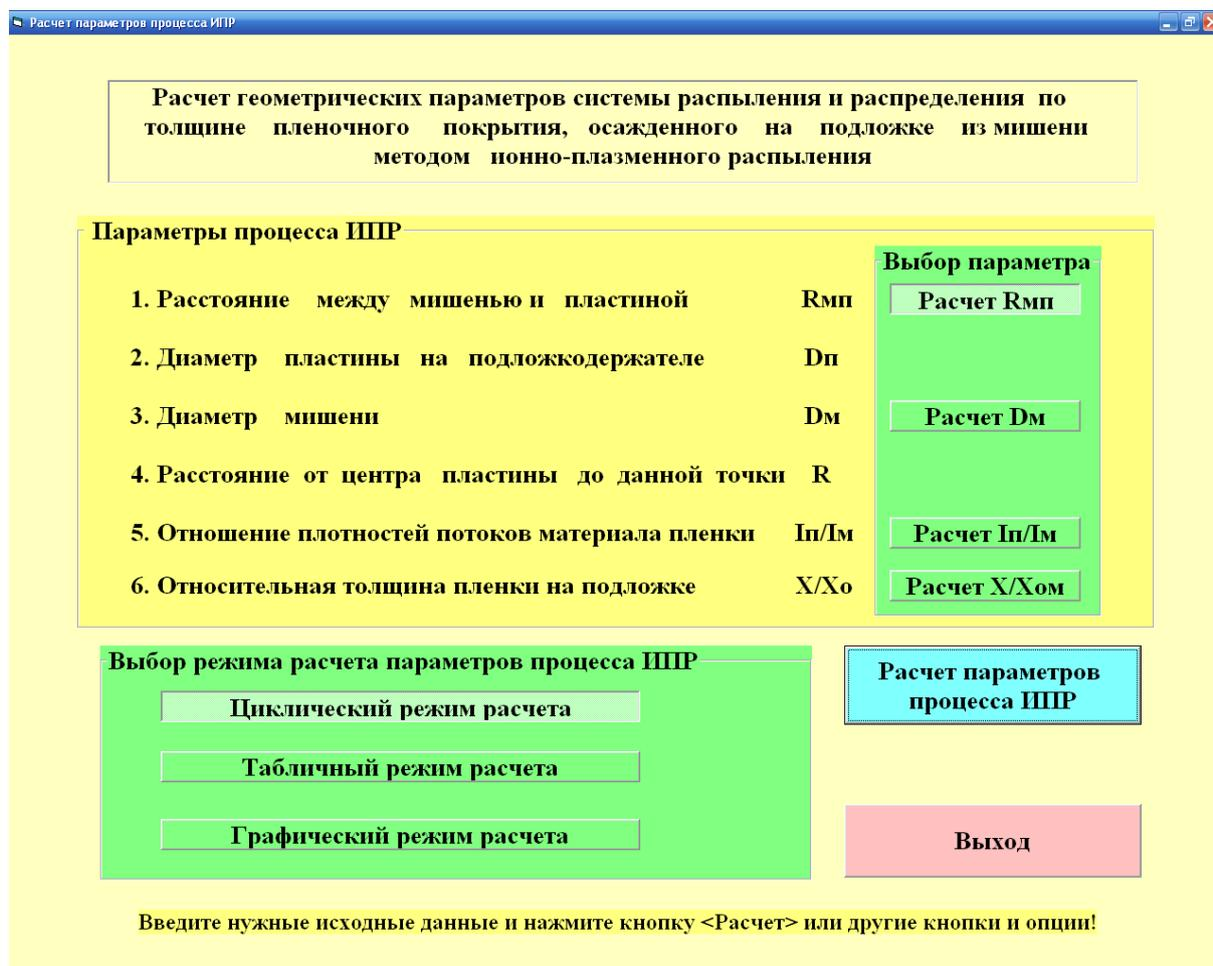
Рис.4.1. Интерфейс программы расчета параметров процесса ионно-плазменного распыления при запуске программы.
