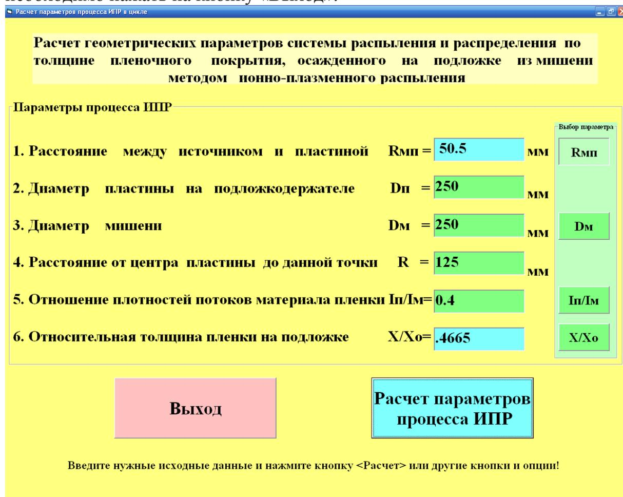
Рис.4.2. Интерфейс программы расчета параметров процесса ионно-плазменного распыления в циклическом режиме работы при расчете значения расстояния от мишени до пластины  $R_{мп}$ .
