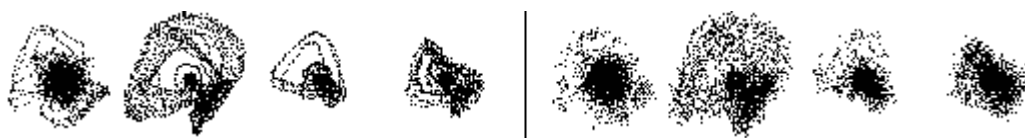
Рис. 1. Фазовые портреты соседних фрагментов акустического речевого сигнала, справа к исходному сигналу добавлен высокочастотный шум
