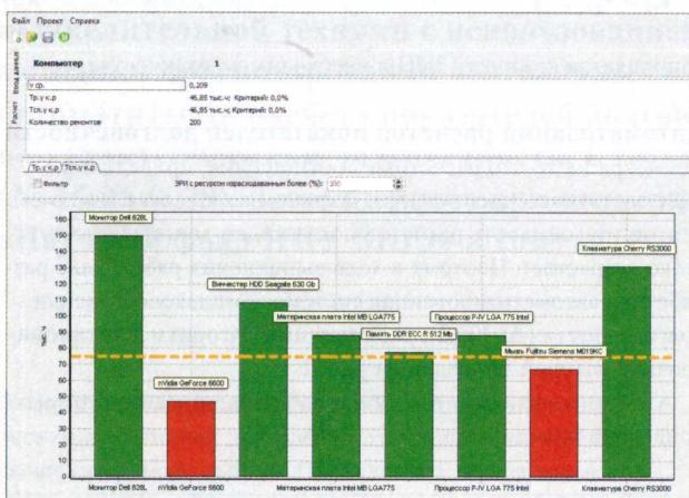
Рисунок 4. Время расчета наработка на отказ электронного модуля
