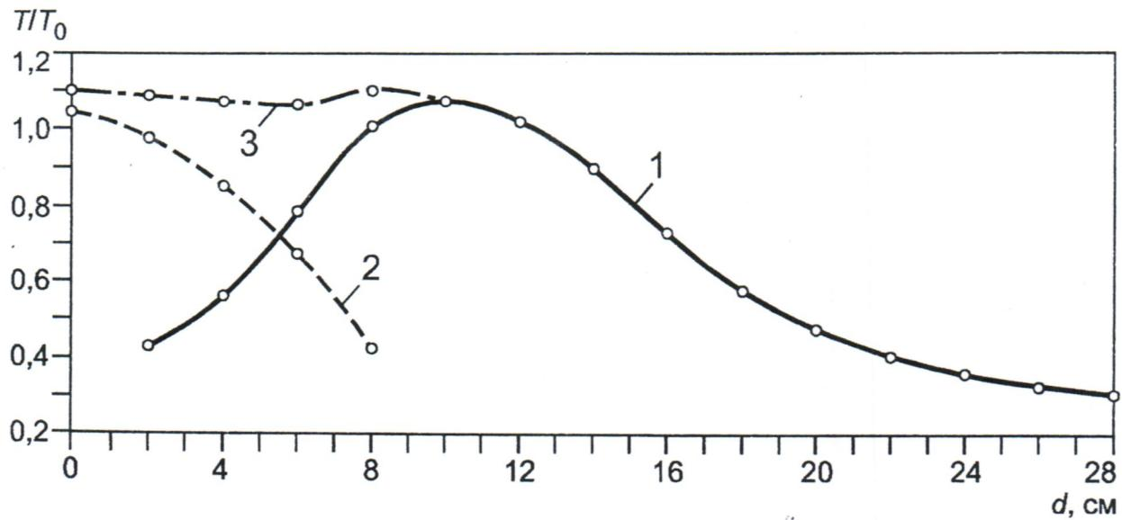
Рис. 2. Распределение температурного поля в материале по слоям:
