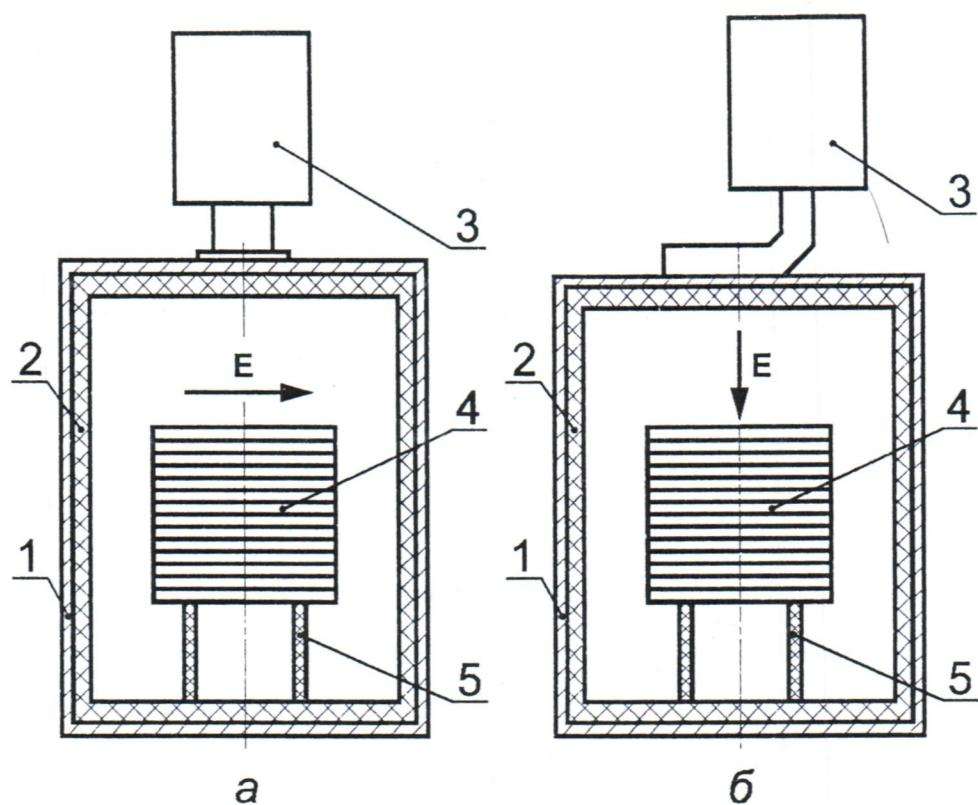
Рис. 1. СВЧ-установка для нагрева объемного диэлектрического материала:
