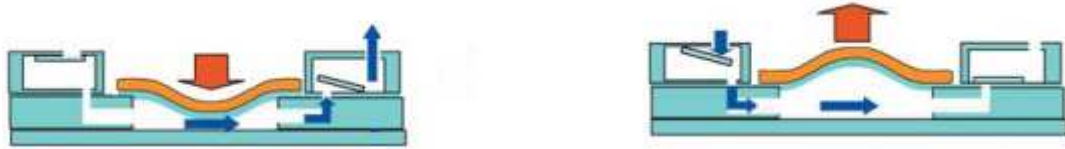
Рисунок 6. Модель мембранного насоса с двухслойной мембраной.
