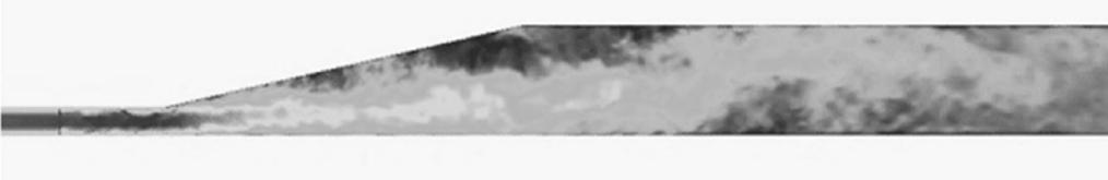
б) Использование EARSМ-LES с генератором синтетической турбулентности
