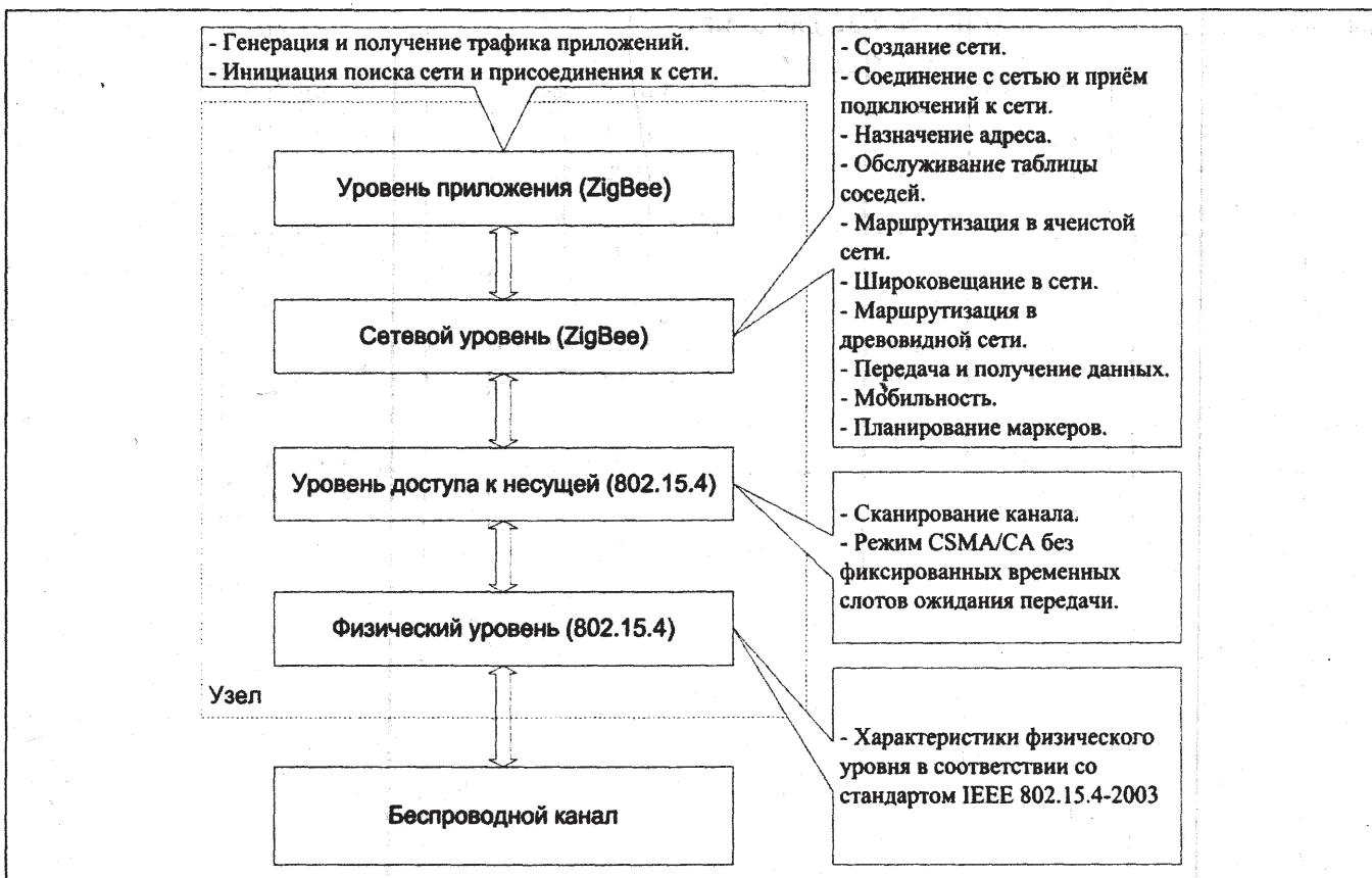
Рис. 3. Встроенная модель OPNET Modeler 14.0
