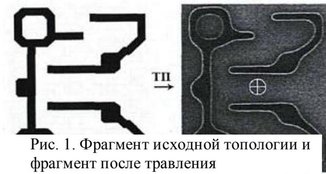
Рис. 1. Фрагмент исходной топологии и фрагмент после травления
