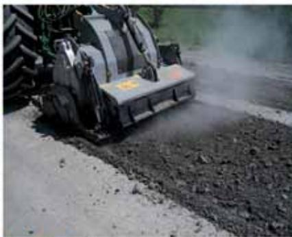
**RSL 225:** 3 в 1 - фреза асфальта, стабилизатор грунта, измельчитель камней. Захват 2200 мм, макс. заглубление 270 мм.
