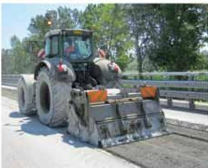
**MTH 225:** 3 в 1 - фреза асфальта, стабилизатор грунта, измельчитель камней. Захват 2320 мм, макс. заглубление 500 мм.
