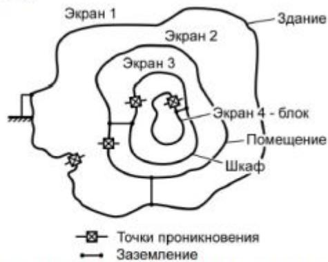
Рис. 1. Топологическая модель системы экранирования
