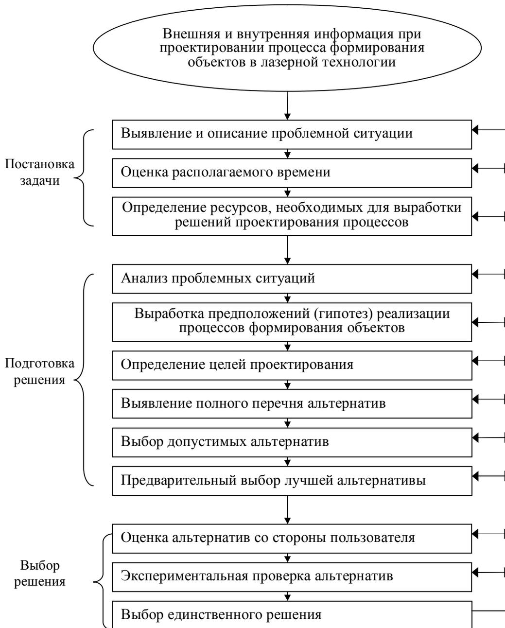
**Рис. 2.1.1.** Структура принятия решения в лазерной технологии
