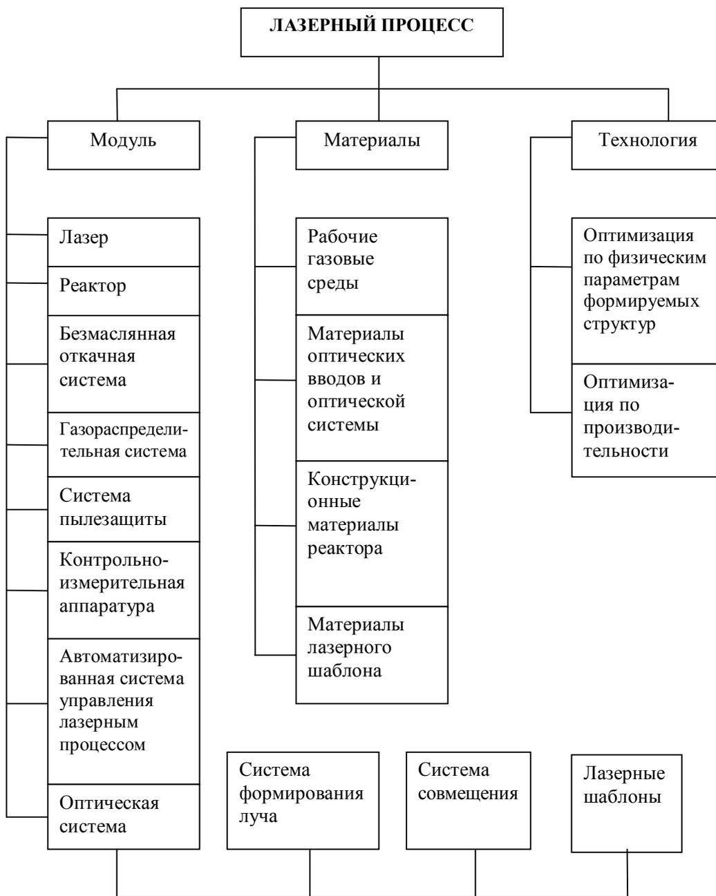
Рис. 2.1.4. Структура лазерного процесса
