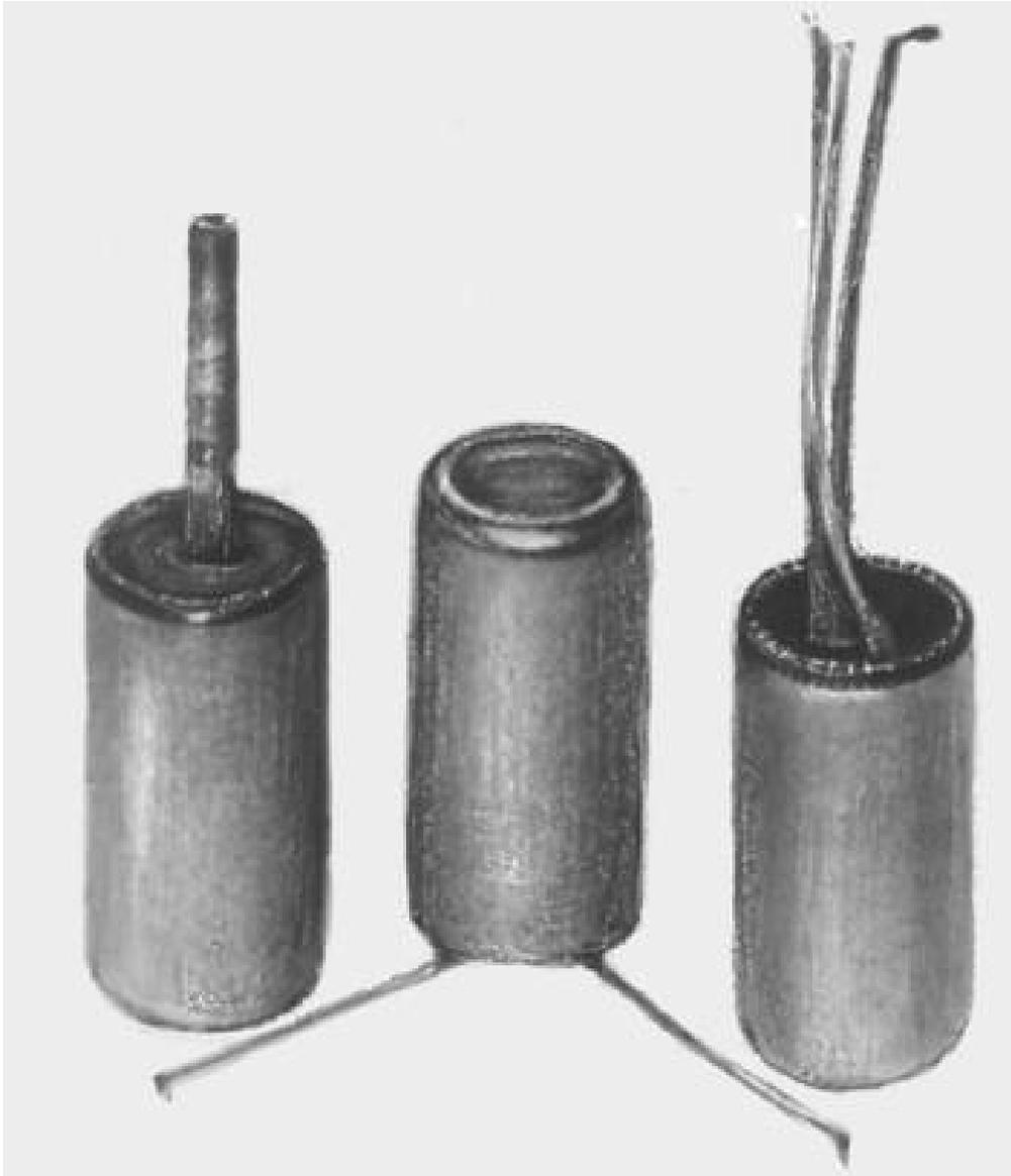
**Рис. 1.3.1,г.** Лазерная сварка: полупроводниковые приборы, корпуса которых герметизированы с помощью лазерной сварки
