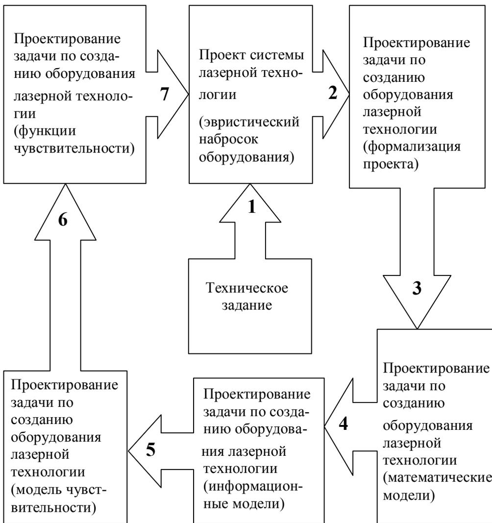
**Рис. 2.2.2.** Схема процесса автоматизированного проектирования для производства объектов в лазерной технологии
