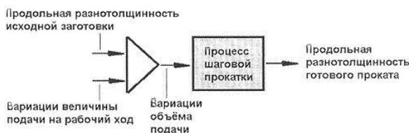
Рис. 3. Структура модели определения величины продольной разнотолщинности готового проката в зависимости от изменения объема подачи при шаговой прокатке
