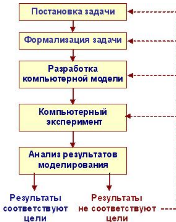
Рис. 6. Блок-схема процесса компьютерного моделирования
