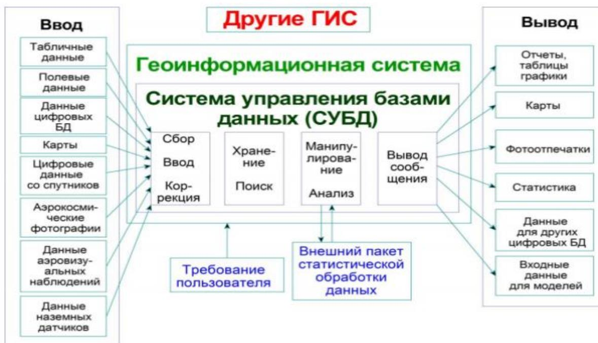
Рисунок 4 – Общая схема функционирования геоинформационной системы
