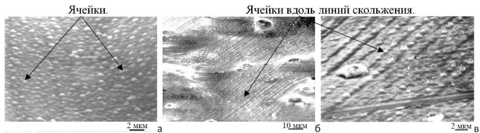
Рис. 6. Микроструктура участков поверхности образца №3 сплава Cu-4%Ni-10%Ga после облучения в установке ПФ в эксперименте №1: q_{pl} = 10^8 Вт/см 2 , \tau = 100 нс, q_i = 10^8 - 10^9 Вт/см 2 , \tau = 50 нс, число имп. N=4 (СЭМ)
