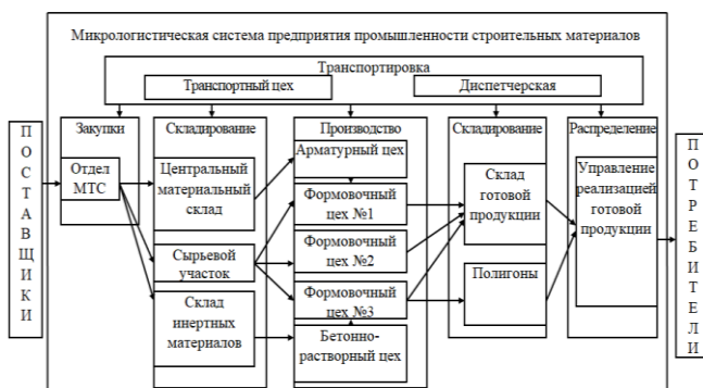
Рис. 1. Схема микрологистической системы предприятия промышленности строительных материалов
