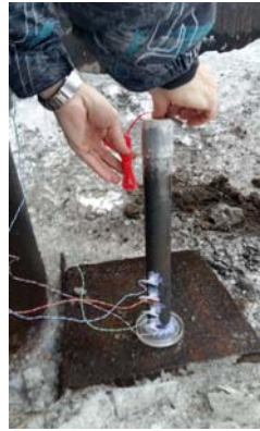
Рис 1. Измерение скорости детонации в стальной трубе
