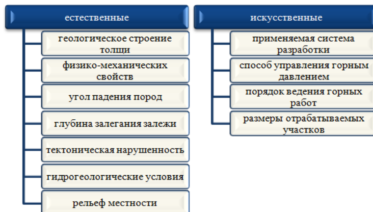
Рис. 2. Факторы, влияющие на сдвижение земной поверхности и горных пород при подземной разработке месторождений
