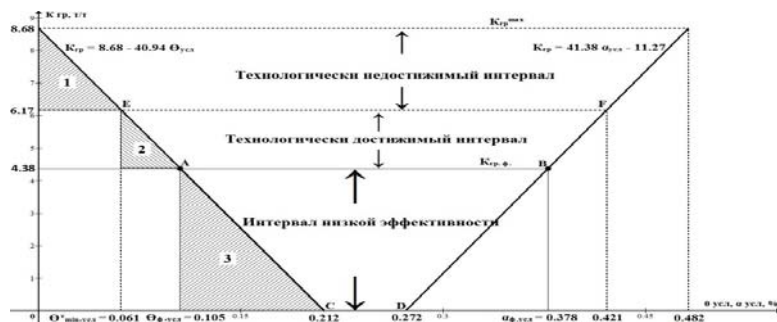
Рис. 1. Графики зависимостей граничного коэффициента вскрыши от содержаний условной меди в хвостах обогащения и перерабатываемой руде
