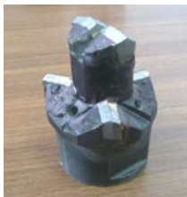
Рис. 4. Коронка с опережающим лезвием
