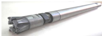
Рис. 3. Опытный образец пневмоударника ПНБ76 с коронкой КНБ76
