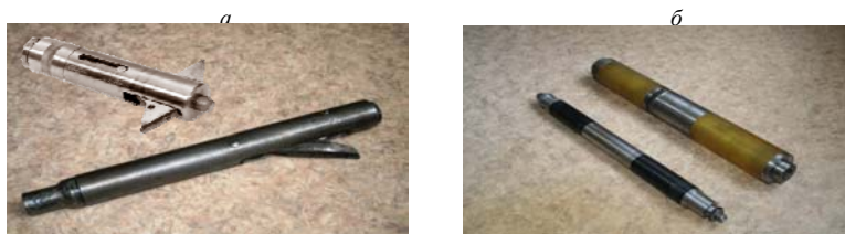
Рис. 1. Оборудование для проведения направленного и поинтервального гидроразрыва угольного пласта:
