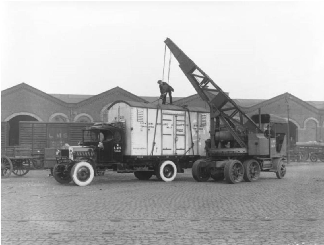
Рисунок 3 - Контейнеры железной дороги London, Midland & Scottish Railway (Лондон, 1933). Металлические контейнеры, обшитые деревом, были приспособлены как для железнодорожной, так и для автомобильной транспортировки и использовались для доставки мяса и других товаров, которые требовали быстрой перегрузки на станциях
