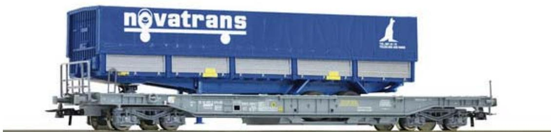
Рисунок 26 - *Pocket wagon 1a* для перевозки полуприцепов (модель). Источник: <https://www.hobbytrix.nl/product/88114/76747-standard-pocket-wagon-sncf>
