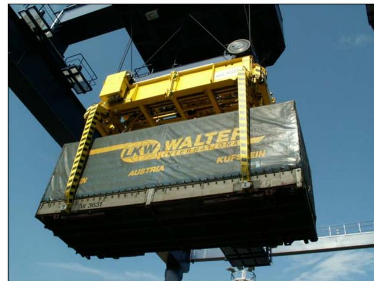
Рисунок 23 - Съемные кузова. Установка на шасси автомобиля (вверху слева); СК с раскрывающейся боковой стенкой (вверху справа); обработка СК на складе (внизу слева); перегрузка на интермодальном терминале (внизу справа).
