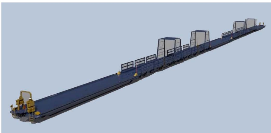
Рисунок 30 - Вагоны, используемые в Евротуннеле. Источник: сайт компании *WBN Waggonbau Niesky*
