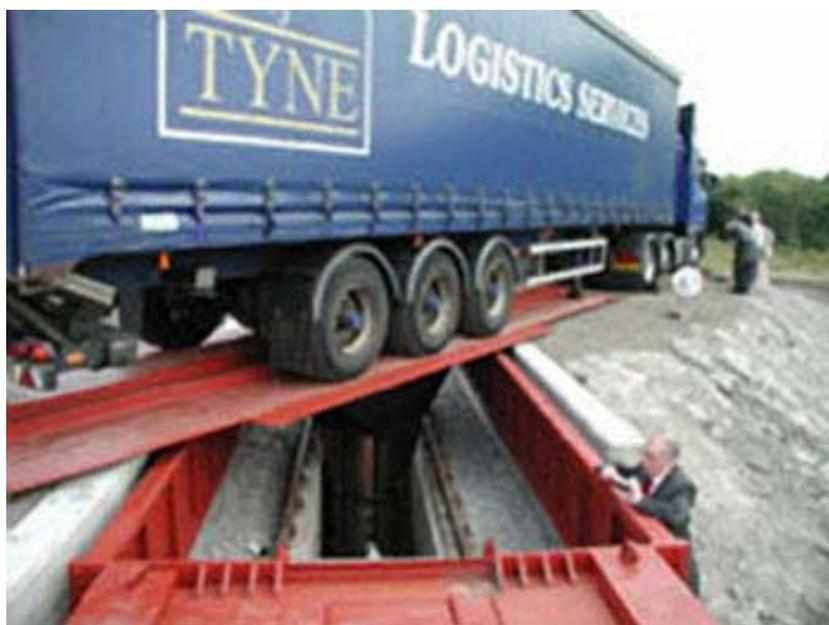
Рисунок 33 – Вагон и погрузочное устройство системы *Cargospeed*
