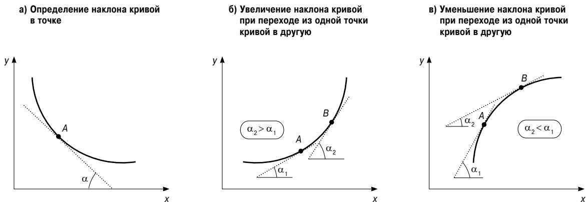
Рис. 1.8. Наклон кривой при нелинейной зависимости и его изменение при движении вдоль кривой
