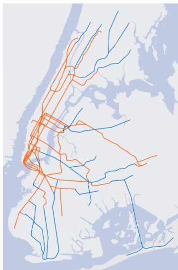
Рисунок 19 – Сеть линий метрополитена г. Нью-Йорк: красные участки подземные, синие – надземные и наземные
