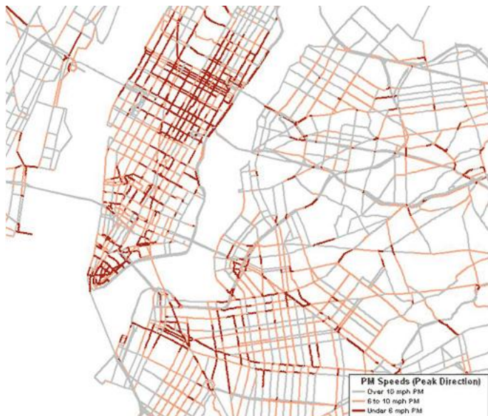
Рисунок 1 – Места основных пробок в Нью-Йорке (Скорость движения автомобилей указана в милях в час; чем коричневее, тем оно медленнее)
