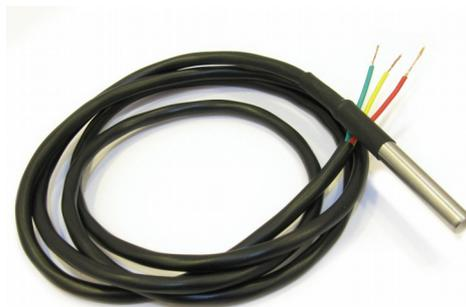
**Figure 18. DS18B20 Water-proof temperature sensor**
