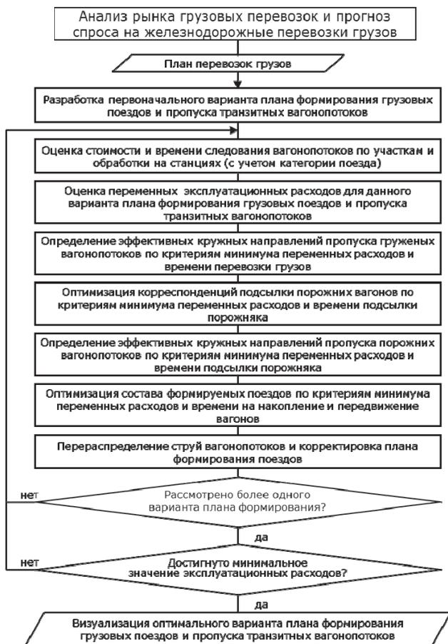
**Рис. 4.1.** Укрупненный алгоритм планирования грузовых вагонопотоков на основе переменных расходов и других экономических критериев
