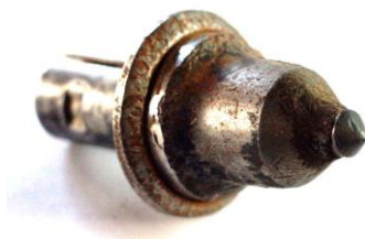
Рис. 6. Опытный резец после проведения испытаний
