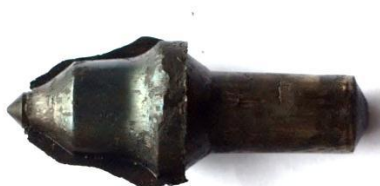
Рис. 5. Заготовка резца после деформации
