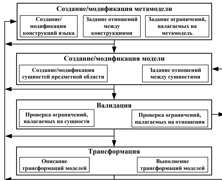
Рис. 1. Порядок разработки моделей в системе MetaLanguage
