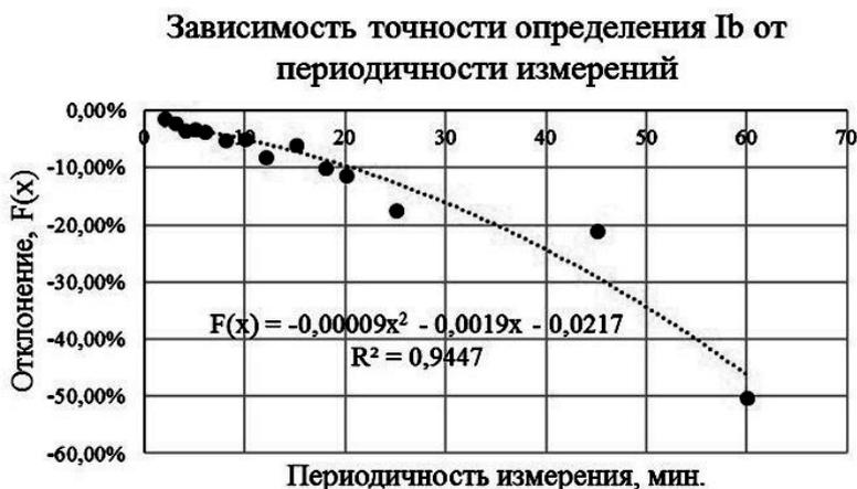
Рисунок 4. Динамика зависимости точности определения  $Ib$  при различных интервалах проведения замеров при отсутствии светофорного объекта и НПП
