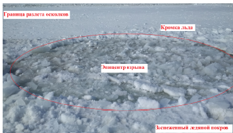
Рис.1. Результаты экспериментальных исследований. Полынья в ледяном покрове. Фото сделано Орловым М.Ю. через 2 минуты после взрыва
