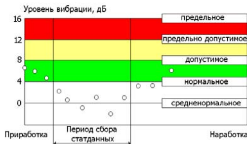
Рис. 1. Схема сбора данных для расчета средненормального уровня вибрации и допустимых значений вибрации различных состояний
