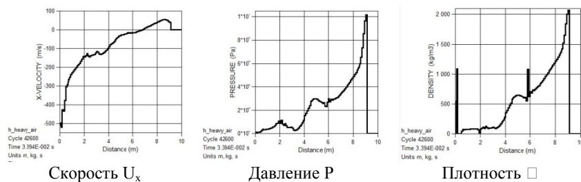
Рис. 3. Рассчитанные графики изменения параметров вдоль характерной горизонтальной прямой линии, расположенной на уровне закладки заряда ВВ в момент времени 0.034 с
