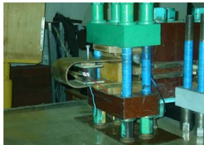
Рис.1. Общий вид установки для исследования основных свойств железистых кварцитов в импульсном магнитном поле с индукцией до 1 Тл.
