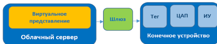
Рис. 3. Передача данных с облачного сервера к конечному устройству
