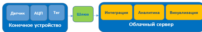
Рис. 2. Передача данных от конечного устройства к облачному серверу
