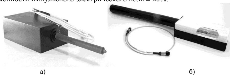
Рис. 6. Средства измерений сверхкоротких электромагнитных импульсов: а) ИППЛ-Р, б) быстродействующий ИППЛ-Л
