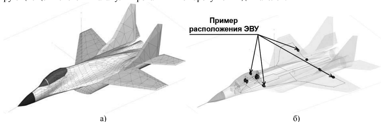
Рис. 1. Расчётная модель образца самолета (а) с элементами кабельной сети (б)
