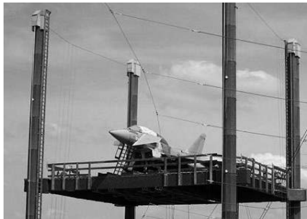
Рис. 4. Диэлектрическая подъемная платформа центра CASSIDIAN EME Test Facility
