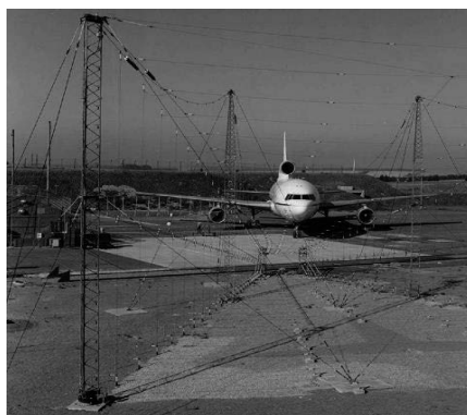
Рис. 2. Сдвоенная логопериодическая антенна центра QinetiQ CEO для формирования вертикально поляризованного поля в диапазоне частот 5–30 МГц
